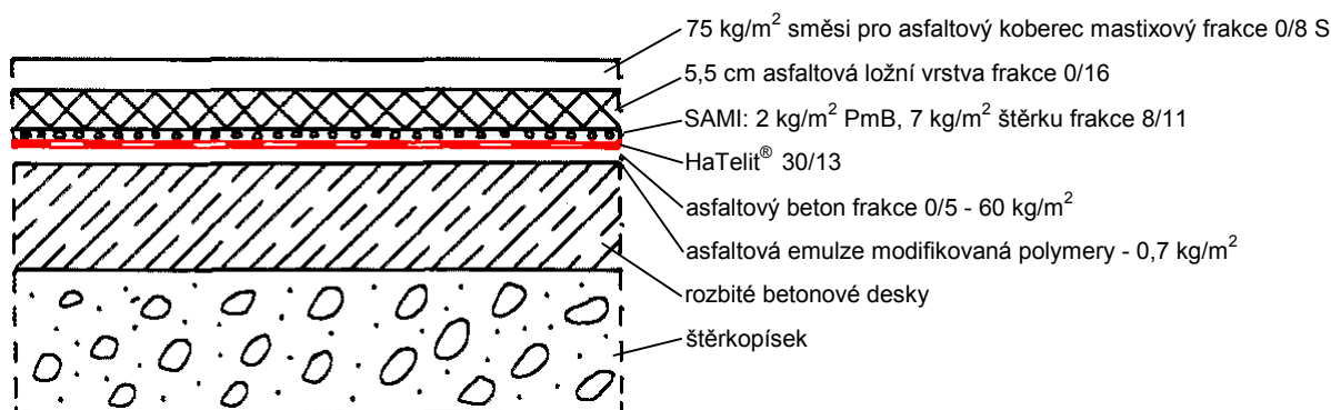
Obr. 7: Schéma skladby konstrukce opravované dálnice Drážďany - Berlín
